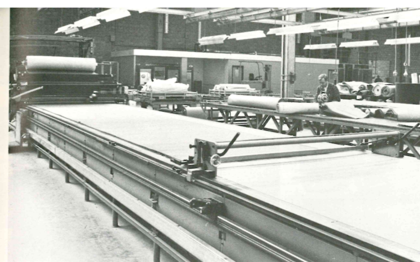
Le chariot étaleur (20 mètres de long) est équipé d'un œil électronique qui arrête l'avancement à la longueur désirée, au millimètre près.
