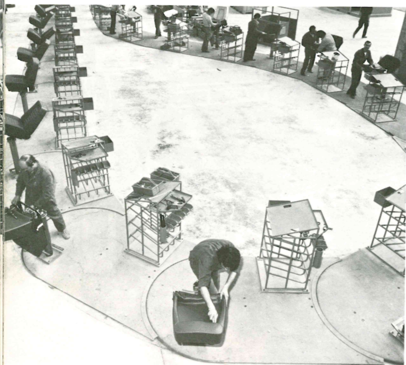
Toute la câblerie de la CX est préparée à l'usine de Rennes-la-Janais : il faut 195 mètres de fil électrique par voiture et 260 extrémités... L'assemblage des faisceaux est réalisé dans un ordre très rigoureux : ici, le faisceau de la planche de bord.
