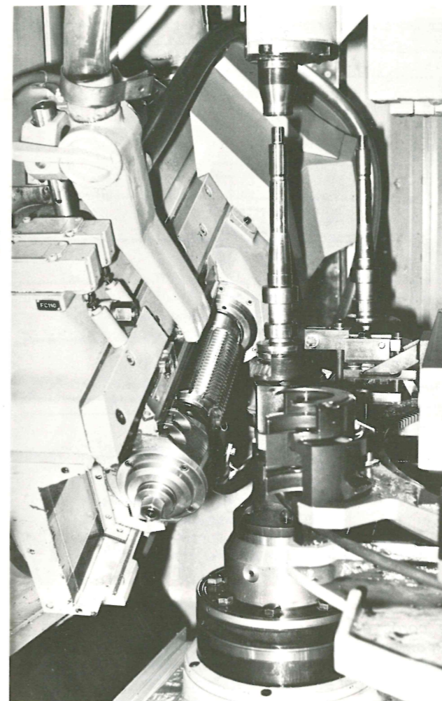
Taillage de l'arbre primaire. La précision finale doit être de l'ordre du 1/100e de mm.
