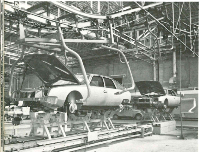
Le coiffage caisse-cadre se réalise en dynamique ; les convoyeurs ne s'arrêtent pas, ils se déplacent à la même vitesse. Deux personnes guident la manœuvre.
