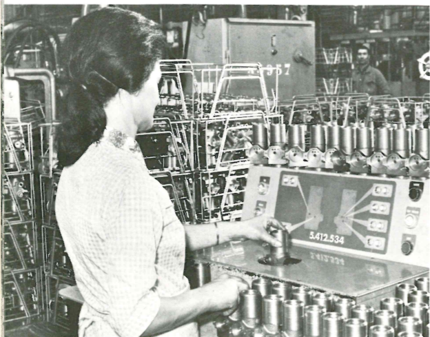
Contrôle du corps du conjoncteur-disjoncteur-accumulateur principal. Le passage d'air comprimé dans tous les conduits permet de vérifier par jauge du débit, qu'ils ont été usinés aux normes strictes.
