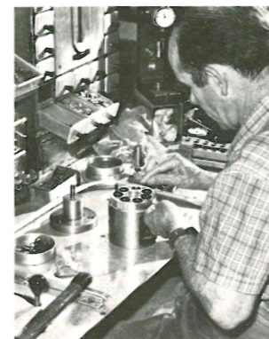
Montage des petits éléments des pistons du corps de la pompe haute pression. Pièce essentielle, son rôle est de faire circuler le liquide dans les circuits en l'aspirant ou en le refoulant par ses sept pistons (suivant équipement), tout en créant la forte pression de 175 kg/cm 2 (175 bars).
