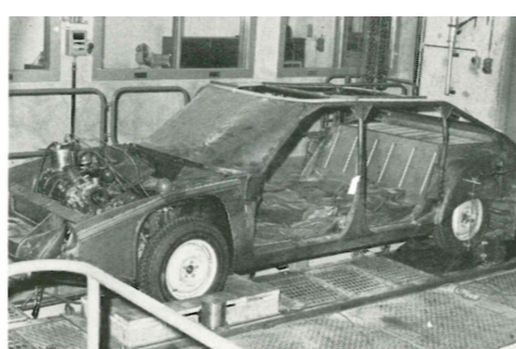
▲ Une Cx-fantôme sur le banc à rouleaux. Seul le soubassement est réel; la forme n'étant pas définitivement déterminée lors de l'essai, la partie supérieure a été simulée par des tubes et des tôles.
